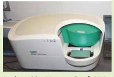
Hochsensitive Messung der cft-DNA zur Erstellung des Tumor-DNA-Profils
